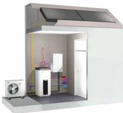
Unité murale combinée à un accumulateur thermique ECH 2 O
